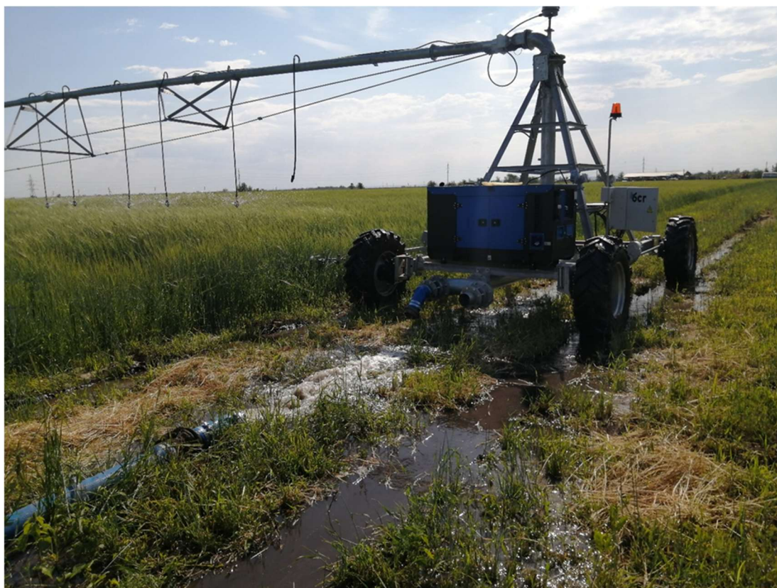
Рисунок 2.12 – Аварийная ситуация – самопроизвольный сход гибкого рукава с посадочного места быстросъёмного соединения центральной подвижной опоры
