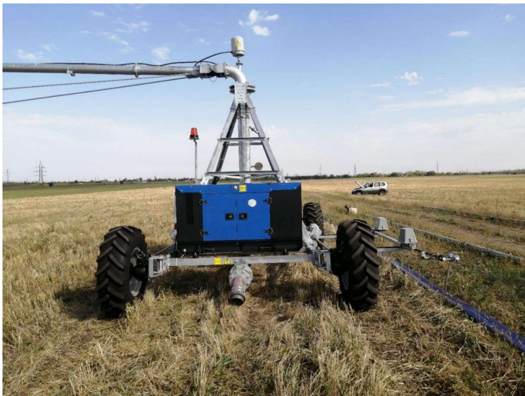
Рисунок 2.8 – Узел ирригационной установки для подключения гибкого рукава по первой схеме
