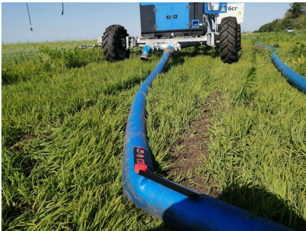
Рисунок 2.9 – Узел ирригационной установки для подключения гибкого рукава по второй схеме
