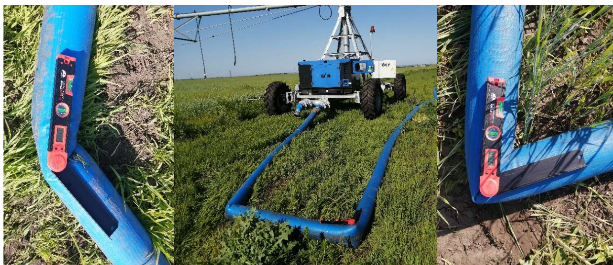
Рисунок 4.2 – Определение угловых величин изгибов рукава в процессе его работы
