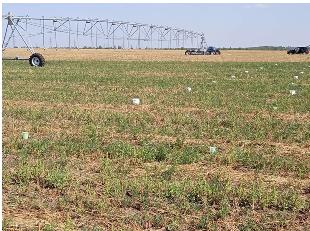
Рисунок 2.3 – Расстановка дождемеров при проведении полевых испытаний универсальной дождевальной машины УДМ «Кубань-А195-57,7-01»
