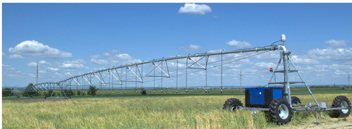
Рисунок 2.1 – Универсальная дождевальная машина УДМ «Кубань-А195-57,7-0,1»
